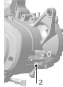
Si el nivel de aceite de la transmisión (o reductora) es demasiado alto, retire el tornillo de drenaje de aceite de transmisión (2 en Figura 2) con una llave de vaso.
