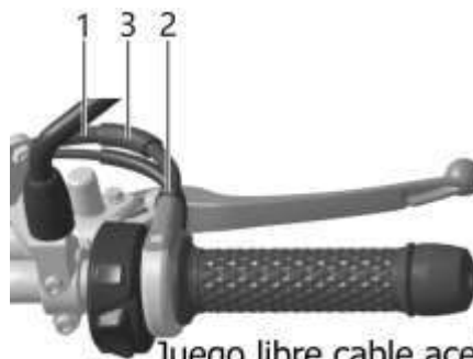
Juego libre cable acelerador 2-4 mm
