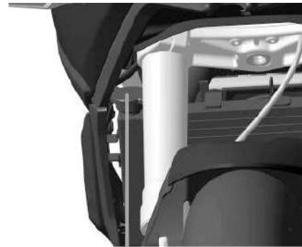
Boca de relleno
